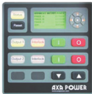
Интерфейс пользователя прост и понятен. Кроме того, AXA 2300 предлагает ряд средств сопряжения с внешними устройствами: • Порт с гальванической развязкой RS485 (протокол JBUS) • TCP/IP /интерфейс Ethernet (протокол MODBUS/JBUS RTU) • USB порт для инженерного пульта • USB порт для вывода данных. Например, журнала ошибок, данных по мощности и т.д.
